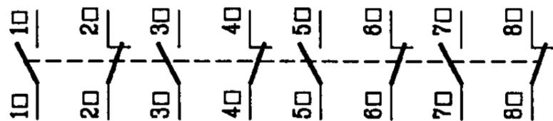
辅助电路接线端子代号的编制示例如下图
