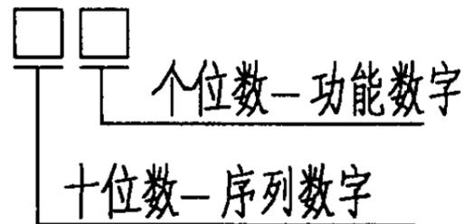
功能数字1、2表示动断触头,3、4表示动合触头;1、2、4表示带转换触头的辅助电路中的接线端子代号;5、6表示带特殊功能动断触头(例如延时)的接线端子代号;7、8表示带特殊功能常开触头(例如延时)的接线端子代号. 示例见下图:
