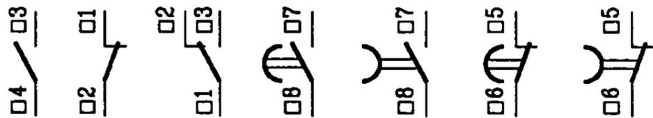
属同一触头的接线端子的序列数字相同;同一元件的所有触头具有不同的序列数字. 示例如下图:
