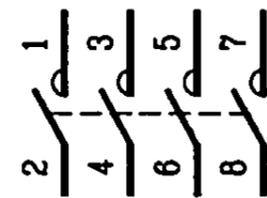
断路器、隔离开关、熔断器的主电路接线端子代号也可采用本方法编制。
