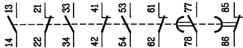
注:无接线端子代号的接触器、继电器参考机械部部标准《低压接触器》JB 2455-85 7.1.3.2编制接线端子代号.
