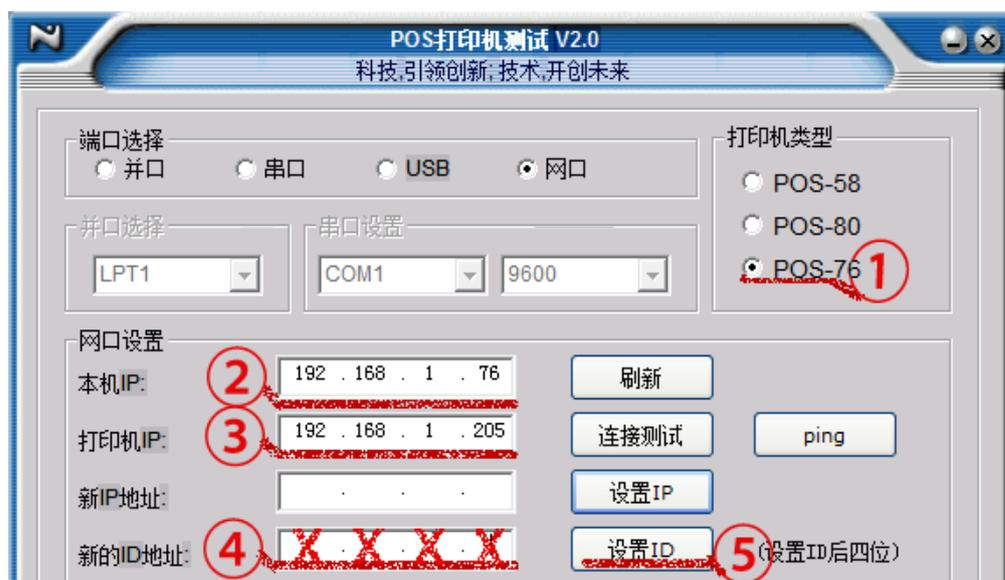
①选择打印机型号---按打印头宽度来分,例如,POS-76为76针打系列打印机
