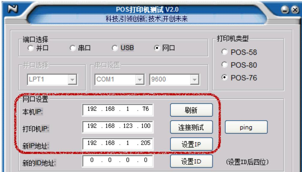
(比如用户当前电脑(或POS 主机)IP 地址为192.168.1.76,打印机实际IP为192.168.123.100),若想在用户当前网段192.168.1 使用打印机,则必须更改打印机IP 到用户当前网段下,假定用户想更改打印机的IP 为192.168.1.205,则按下步骤进行设置:
